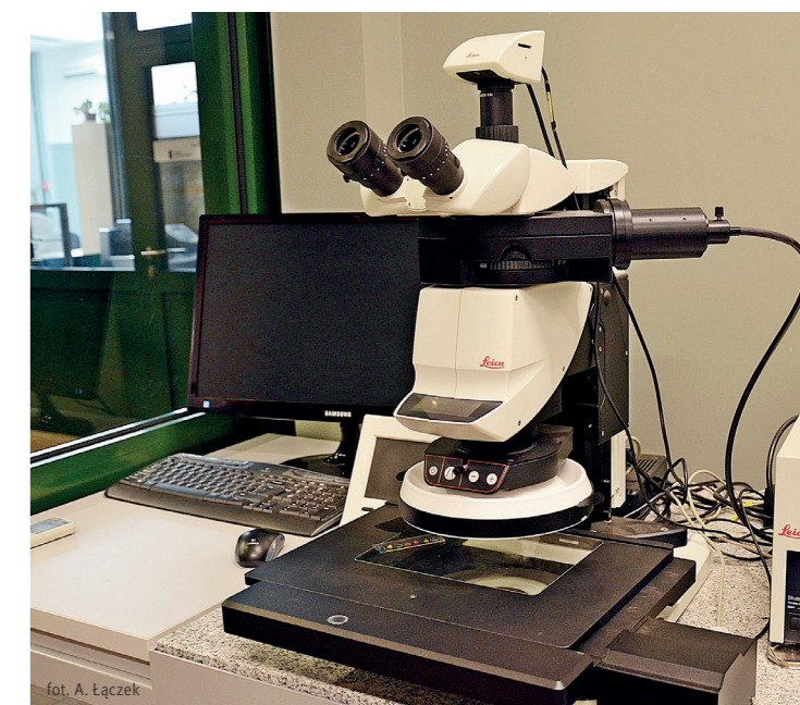
Konfokalny spektrometr ramanowski inVia Reflex firmy Renishaw.
