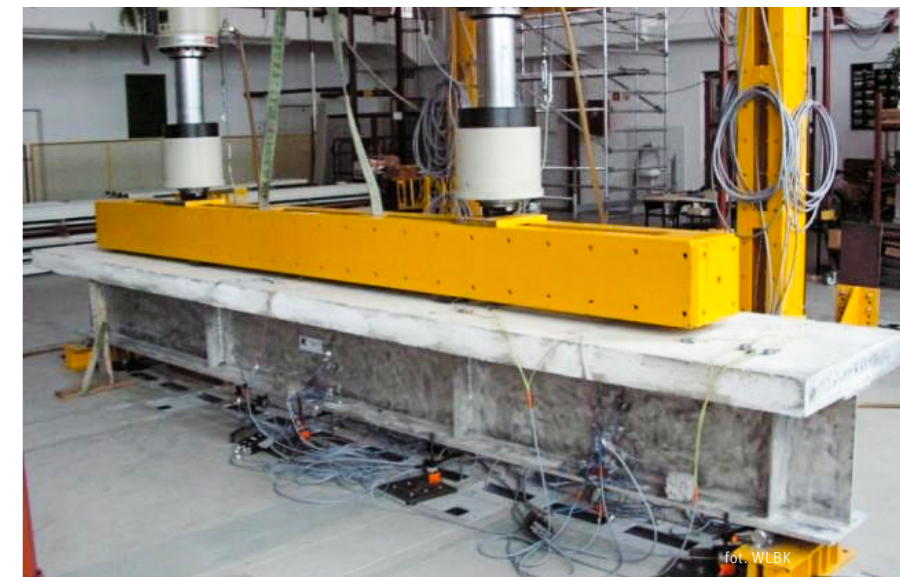
Badania dźwigara aluminiowego zespolonego z płytą żelbetową.
