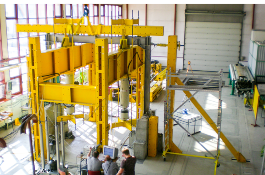
Badania zakotwień słupów stalowych w ścianach istniejących budynków poddawanych renowacji lub rozbudowie.
