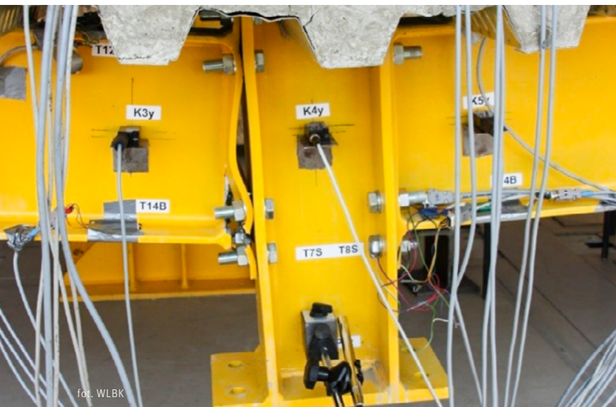
Badania połączenia rygli ze słupem realizowane w ramach grantu dotyczącego stateczności i integralności budynków wielokondygnacyjnych poddanych obciążeniu wyjątkowym.
