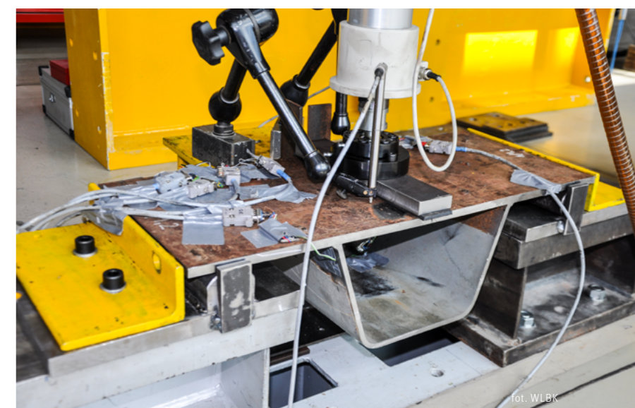
Badania zmęczeniowe fragmentu pomostu ortotropowego mostu im. gen. Grota-Roweckiego w Warszawie.
