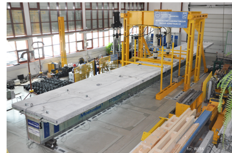
Hala badawcza i system obciążający 2 x 630 kN. Na stanowisku belka mostu kompozytowego o rozpiętości 21 m.
