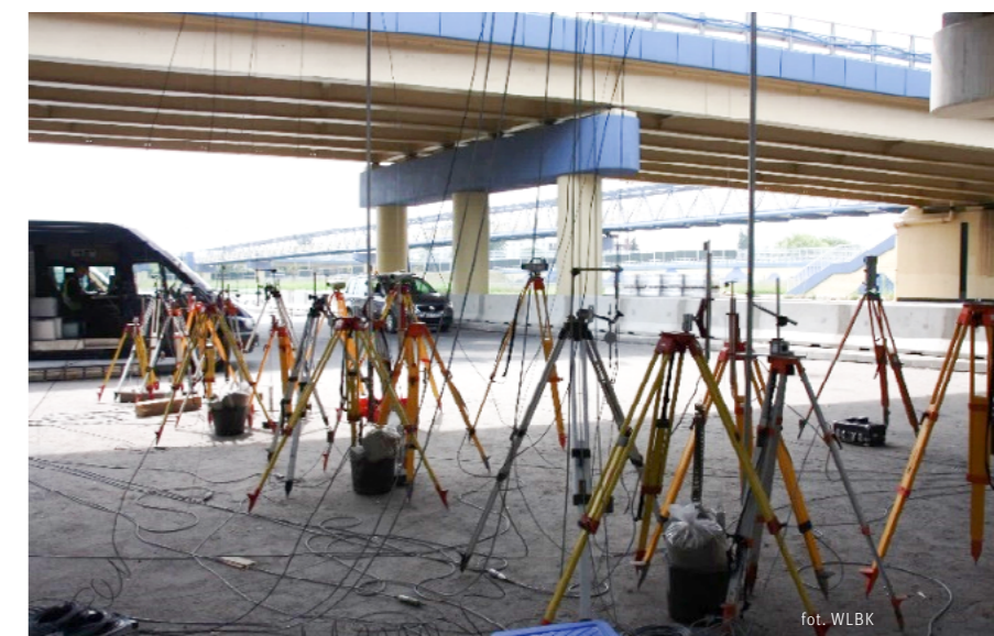
Badania biegotości: pomiary odkształceń, przyspieszeń i ugięć przęsła wiaduktu wykonują jednocześnie cztery laboratoria.
