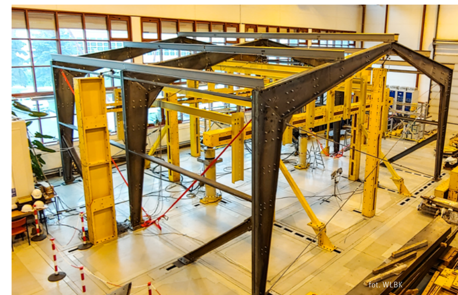
Badania konstrukcji z kształtowników zimnociętych.
