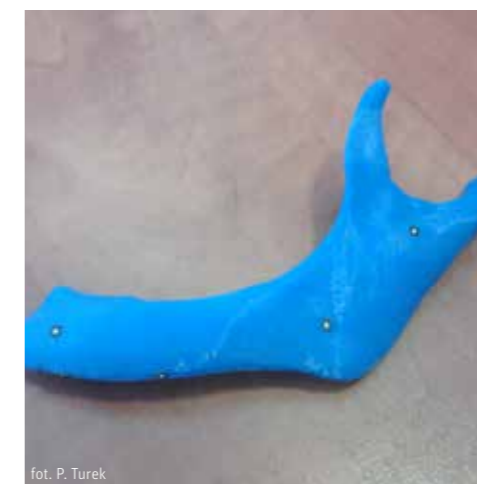
Rys. 3. Modele medyczne wykonane w technologii przyrostowej (po lewej) oraz ubytkowej (po prawej).
