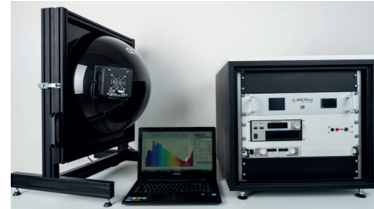
Rys. 1. Stanowisko pomiarowe firmy GL Optic z kulą całkującą 50 cm oraz wpływ temperatury na strumień świetlny \Phi dla wybranego źródła LED dużej mocy
