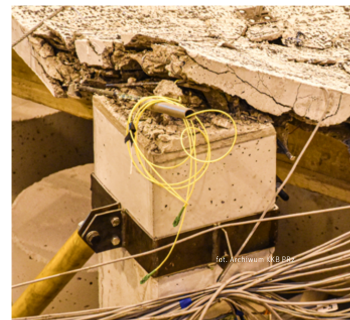
↓ Fot. 9. Zniszczenie fragmentu w wyniku obrotu nad podporą skrajną.
