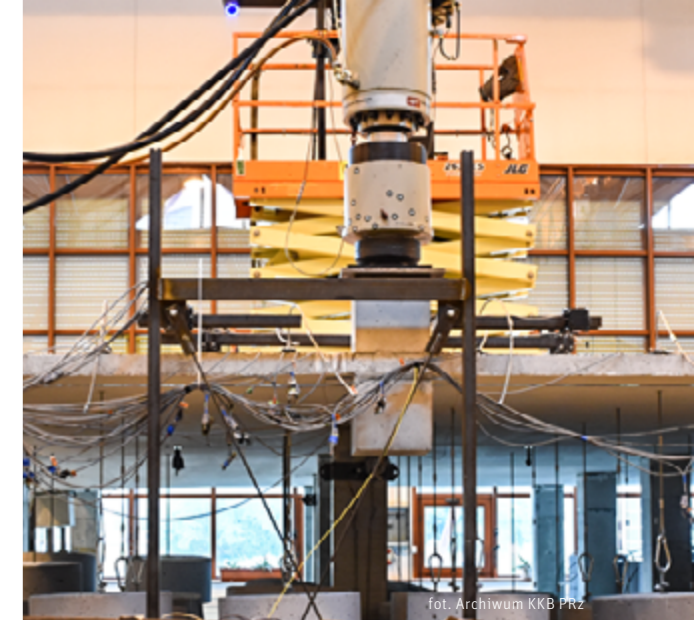
↖ Fot. 6. Symulacja obciążeń stałych i zmiennych stropu.
