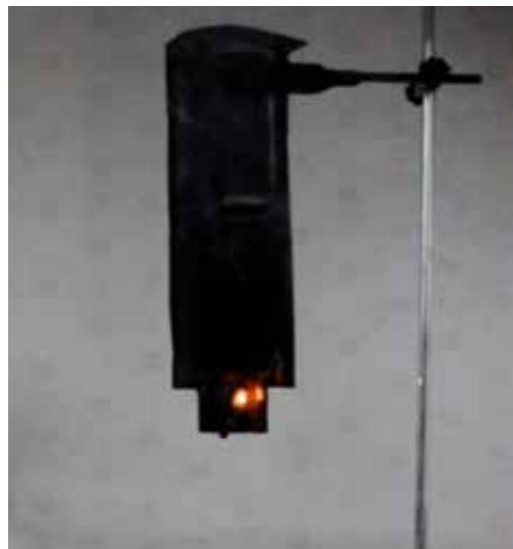
Rys. 3. Kształtki kompozytowe po próbie odporności na płomień palnika gazowego, kształtka wykonana z użyciem opracowanej w ramach projektu kompozycji epoksydowej (po lewej), kształtka wykonana z użyciem epoksydów z handlowymi antypirenami (po prawej).
