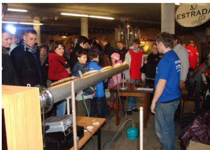
Wizualizacja akustycznej fali stojącej w rurze Rubensa.
