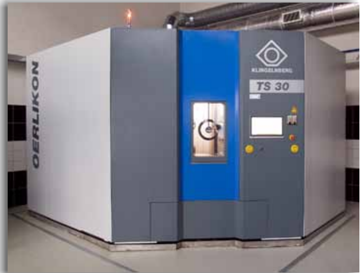
Stanowisko do badań wytrzymałościowych TS30.
