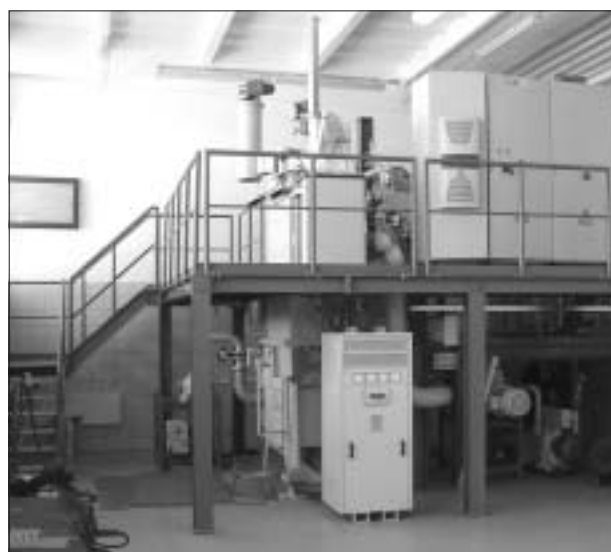
Piec próżniowy do wytwarzania odlewów metodą krystalizacji kierunkowej i monokryształizacji.
