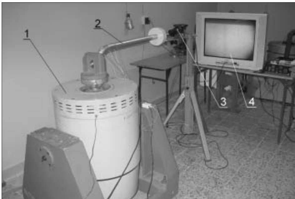
Budowa stanowiska do badań zmęczeniowych: 1 - wibrator elektrodynamiczny, 2 - badany uchwyt zderzaka boczego, 3 - kamera z oświetlaczem, 4 - monitor.
