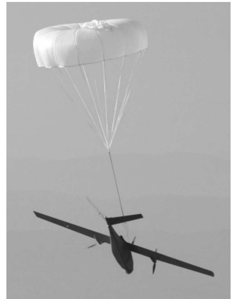
Po wykonanym zadaniu "Wiewiór +" ląduje bezpiecznie na spadochronie.
