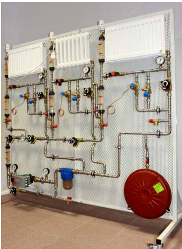
Stanowisko do badania hydraulicznego równoważenia instalacji grzewczych.
