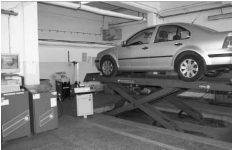
Diagnostyka samochodu na urządzeniach firmy MAHA podczas okresowej kontroli technicznej.
