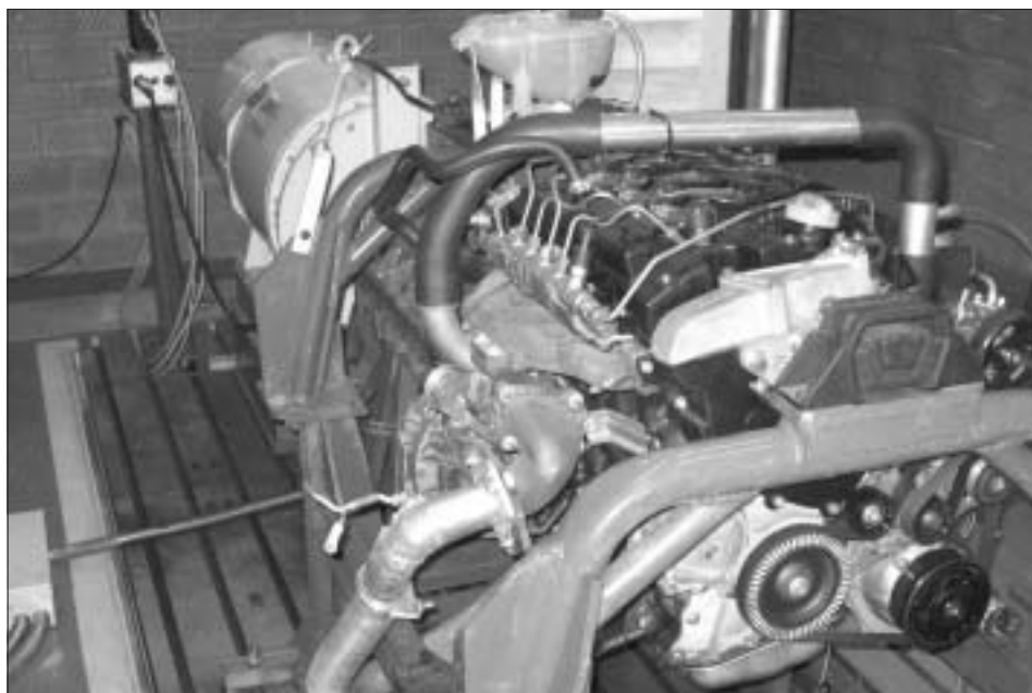
Silnik wysokoprężny Renault G9T z układem wtryskowym Common Rail na stanowisku badawczym z hamulcem prądnicowym SCHENCK DYNAS2.
