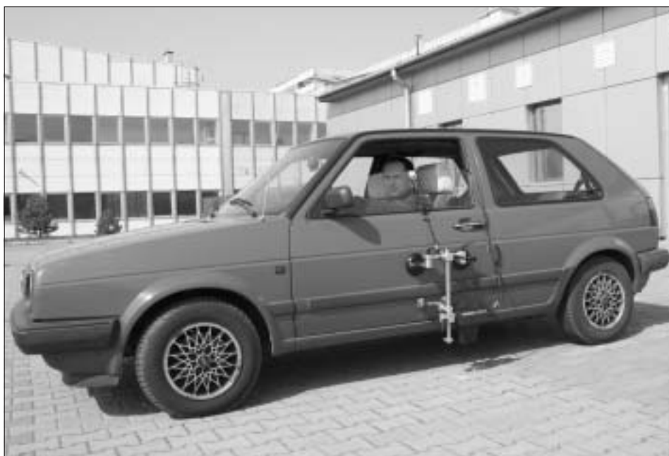
Badania drogowe z wykorzystaniem systemu DATRON do rejestracji parametrów ruchu pojazdu.
