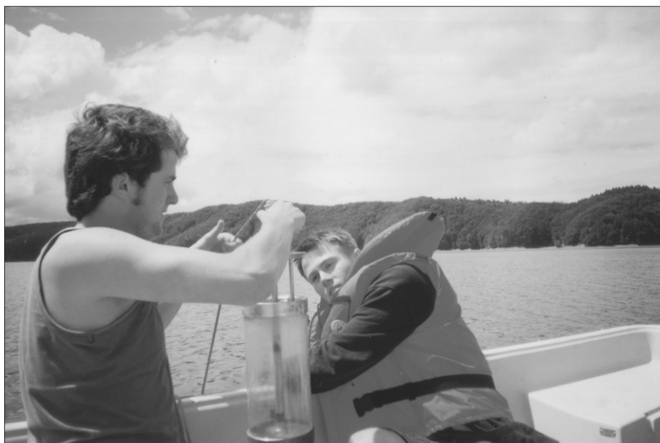
Tomek Marciniak oraz Marcin Wilczyński używają czerpaka Ruttnera do poboru wody z różnej głębokości.
