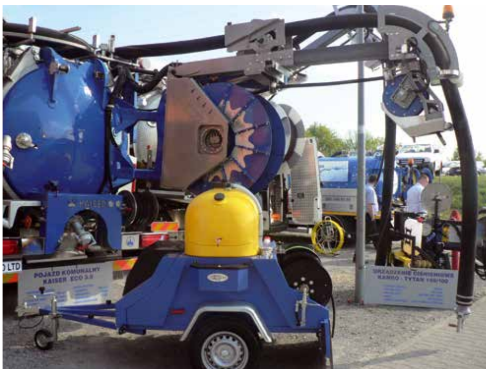
Urządzenia do inspekcji i czyszczenia sieci kanalizacyjnych.
